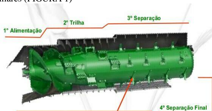
FIGURA 1. Ilustração do sistema STS de trilha e separação por meio de rotor axial. Fonte:< https://pt.slideshare.net/andretop17/sistema-de-trilha-sts9570 >. Acesso em 04 mai. 2017.
