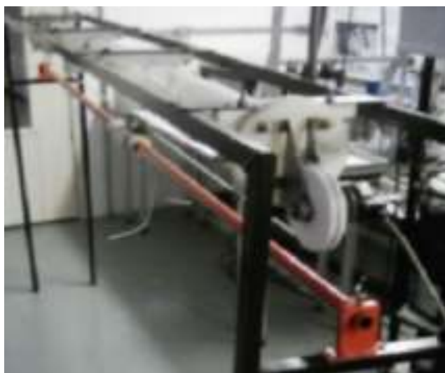
FIGURA 4. Fotografia do elo 2 do protótipo do robô Gantry em construção no NIMASS/UNIJUÍ.
