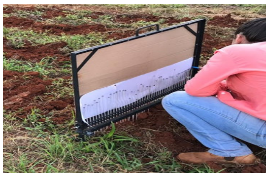
FIGURA 1. Perfilômetro utilizado para a mensuração da mobilização do solo.
