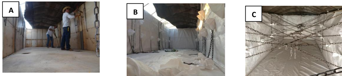
Figura 2. Etapas na instalação do revestimento interno, limpeza da carroceria (A), proteção da carroceria (B) e revestimento total (C), Sorriso-MT, 2016.
