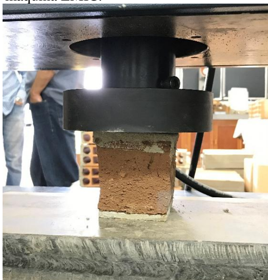
FIGURA 2. Ensaio de compressão na máquina EMIC.
