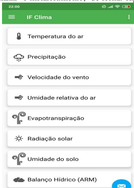
Figura 2. Tela de seleção do elemento climático para monitoramento do clima do aplicativo IFclima.
