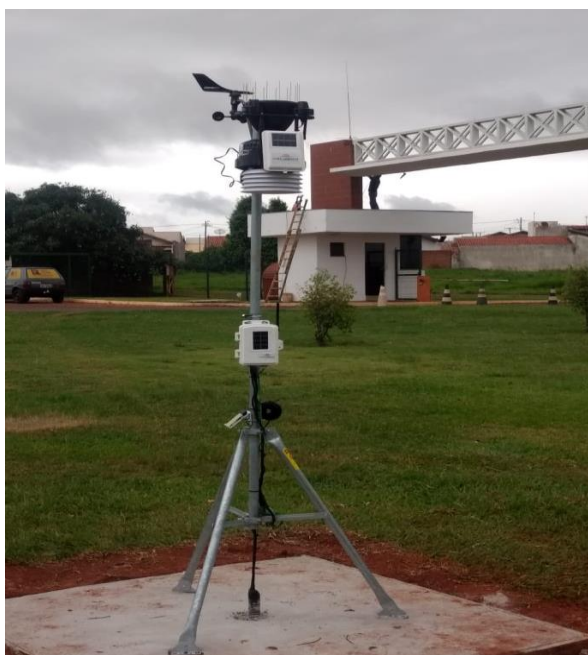
Figura 1. Estação meteorológica utilizada no desenvolvimento do aplicativo.
