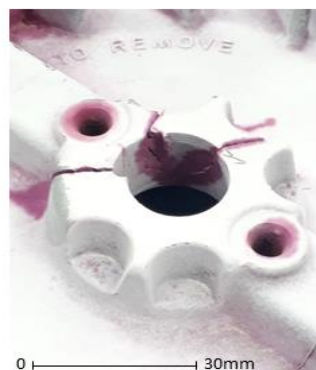
Figura 6. Trincas apresentadas no suporte central do volante
