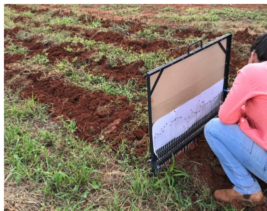
FIGURA 1. Instalação do perfilômetro para a avaliação dos valores de mobilização do solo.
