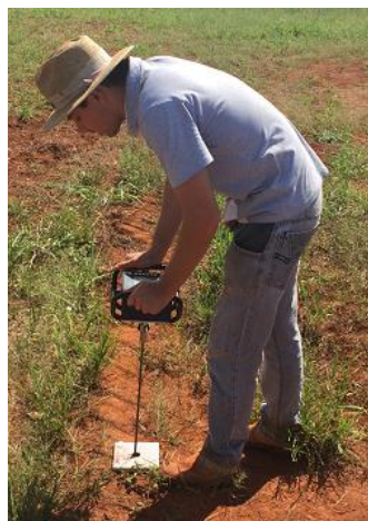
FIGURA 1. Instalação do perfilômetro para a avaliação dos valores de mobilização do solo.
