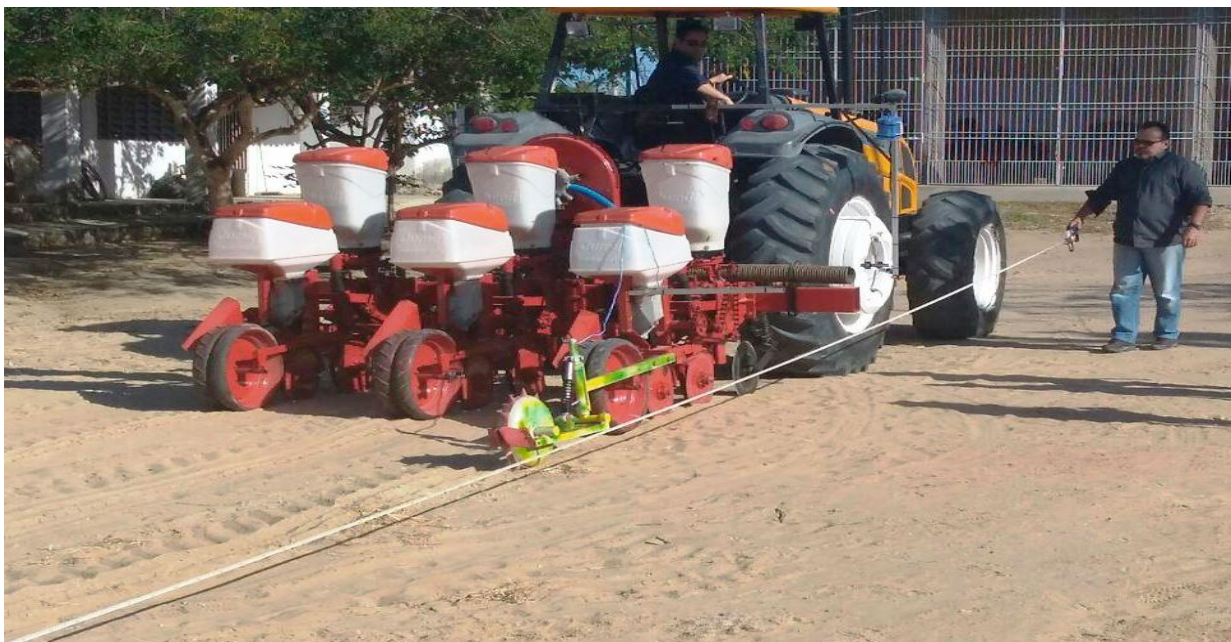
FIGURA 2. Roda odométrica acoplada à semeadora-adubadora.
